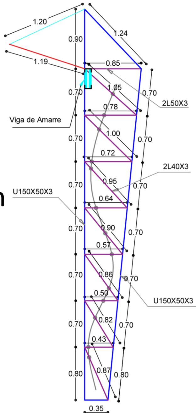
**DETALLE DE PILAR ESTRUCTURAL DE PILAR TIPO 1**
